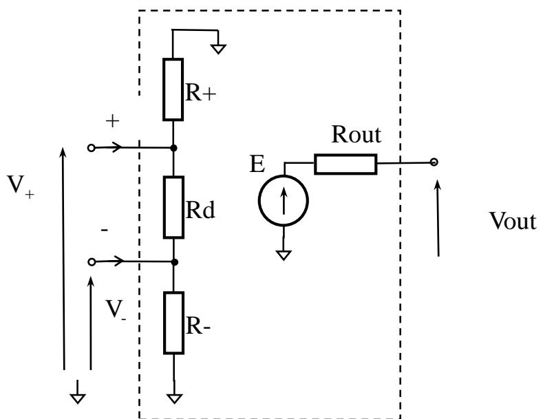
$$E = G_d(V_+ - V_-) + G_{cm}\left(\frac{V_+ + V_-}{2}\right)$$
